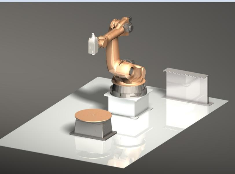
*La soluzione robotica CNC per lavorazione marmo a 5 assi in continuo e posizionamento*
